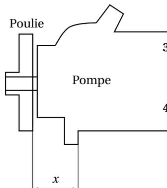
L'installation de la poulie est considérée comme conforme lorsque la cote  $x$  appartient à l'intervalle  $[39,85 ; 40,15]$ .
